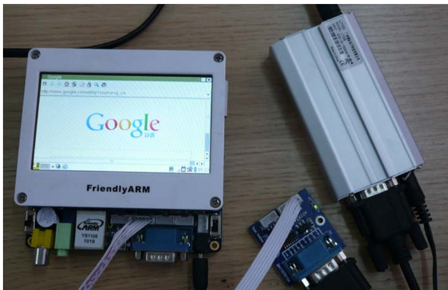
通过串口连接 GPRS Modem 拨号上网
