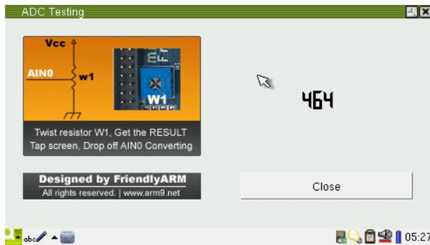
如果你使用的是 ARM 本身自带的触摸屏接口，当你点击触摸屏时，A/D 转换器将会选择触摸屏通道，这时转换结果会显示为“-1”，当触摸笔离开触摸屏，A/D 转换器又会选择板上的 AINO 通道了。
