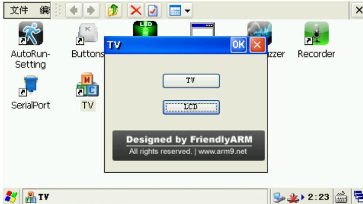
此时把电视输入设置为 CVBS，并与目标板之间使用黄色的视频线连接好，点“TV”，则 LCD 上的输出消失，画面转到了 TV，如图。
