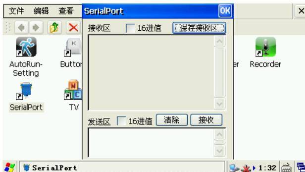
点“设置”按钮，打开设置窗口，设置串口号为 COM2，波特率为 115200，其他设置如图(右上)，点确定返回主窗口。
