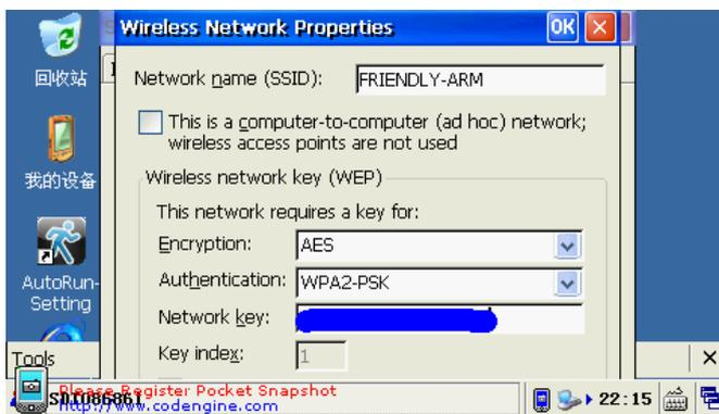
点右上角的“OK”返回，设置窗口会出现连接提示信息，连接成功，如图所示。
