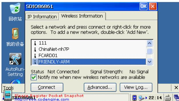
选中一个无线网络，点连接，开始设置无线网，根据自己的实际情况，选择加密类型，并输入密码，如图。
