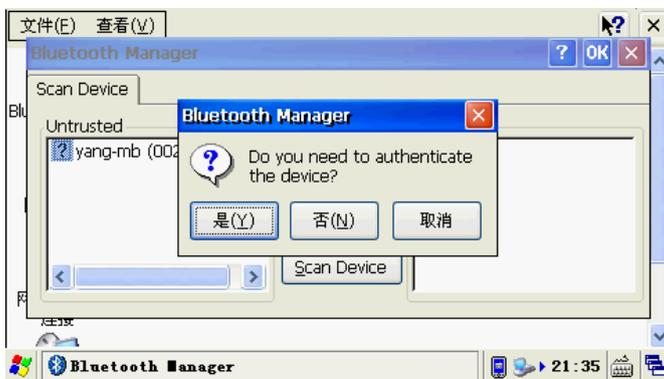
点“是”，会出现一个 PIN 验证对话框，随便输入几个数字，如“111”，此时在手机端会出现一个请求对话框，输入同样的“111”，则信任设备被加入到右边，如图：
