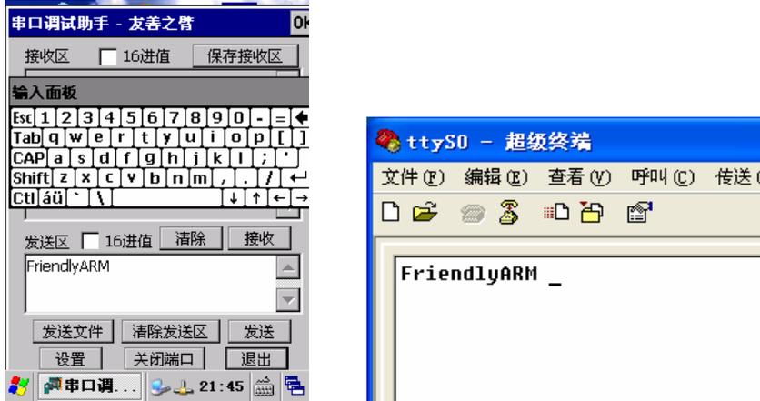
然后，在串口调试助手的主窗口点“接收”按钮（该按钮会改变为“不接收”），在 PC 端的串口终端输入一些字符(通过超级终端是无法看到的)，在输入的同时，我们看到输入的字符会在开发板串口调试助手的接收区显示，如图：
