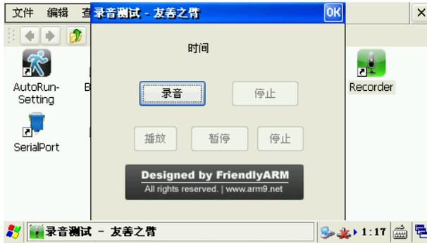
根据提示，点“录音”按钮开始录音，这时对着板上的麦克风说话，程序开始录音，点“停止”按钮结束录音，如图：
