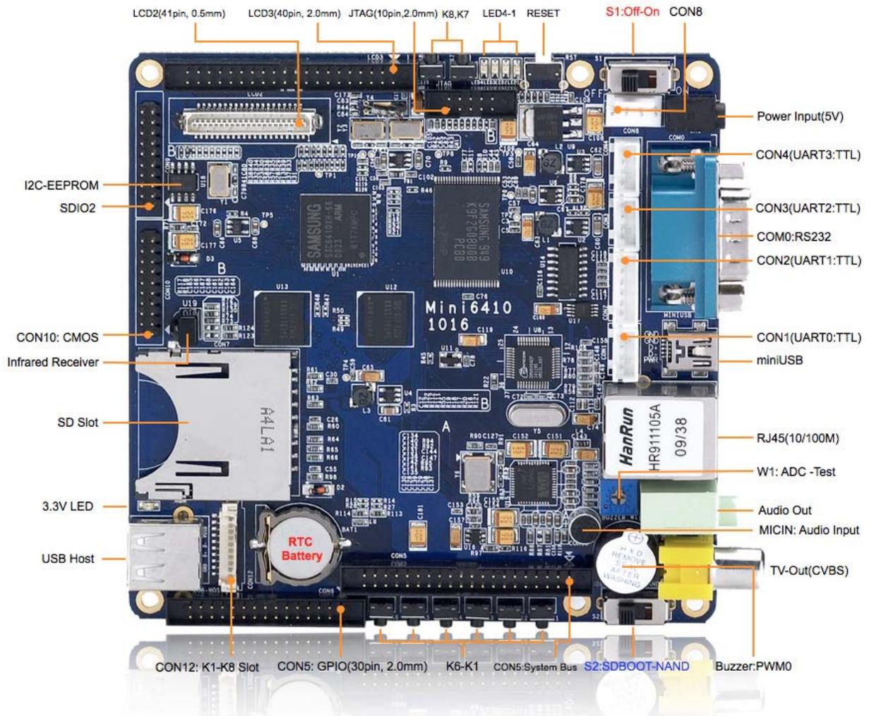
Mini6410 是一款十分精致的低价高品质一体化 ARM11 开发板，由广州友善之臂设计、生产和发行销售。它采用三星 S3C6410 作为主处理器，在设计上承袭了 Mini2440 “精于心，简于形”的风格，而且布局更加合理，接口更加丰富，十分适用于开发 MID、汽车电子、工业控制、导航系统、媒体播放等终端设备；也可适用于高校教学、嵌入式培训、个人研究学习和 DIY 等。
