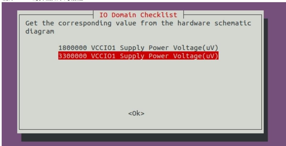
弹出这个对话框目的是检查实际硬件原理图和软件dts的GPIO电压是否匹配，需要根据硬件原理图的实际设计电压来选择（对话框中选择的值不会保存到dts中，dts需要手动去修改）。如果你是软件工程师请与你们的硬件工程师一起核对确认，这个很重要。如果GPIO电压配置不对会导致芯片GPIO烧坏。当你正确确认GPIO电压后这个对话框就不会在弹出（输入值和dts配置的值相同），如果dts名字或者dts里面的io-domian发生变化，则会在继续弹出进行确认。
