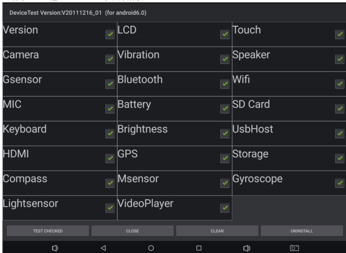
在产线可以根据这个界面进行对应外设的测试，测试时点击“TEST CHECKED”对所测项目逐项进行测试，测试如果成功点击 pass，失败点击 failed，最终结果会显示在界面上，如下图所示，红色为 failed 项，其余为通过项，工厂可根据测试结果进行相应的维修。另外，如果客户需要对该工具进行定制，请联系 FAE 窗口申请对应的源码。
