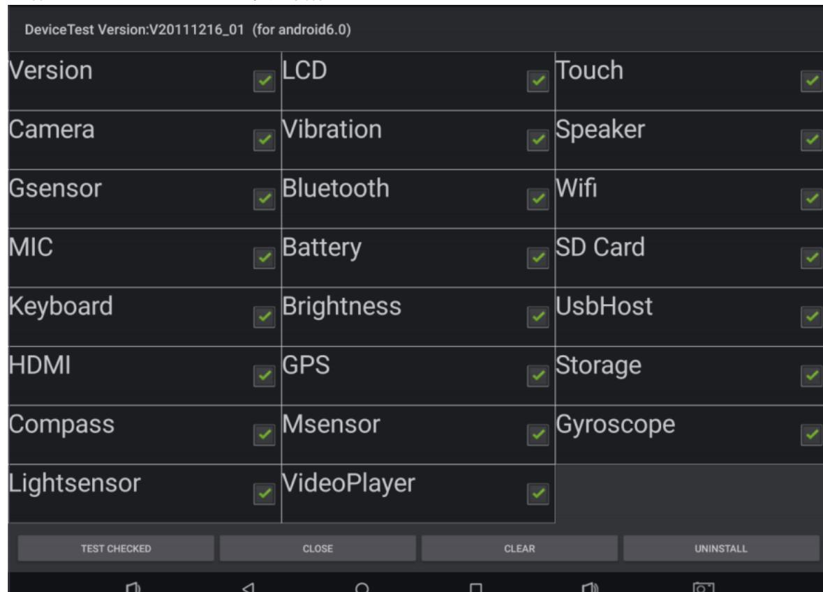
在产线可以根据这个界面进行对应外设的测试，测试时点击“TEST CHECKED”对所测项目
