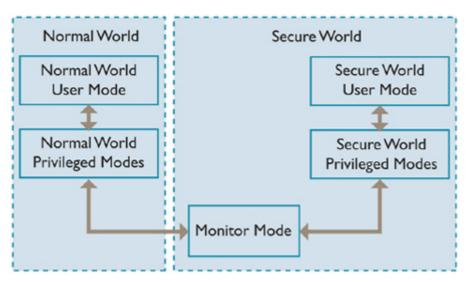
可通过以下方式确保系统安全:隔离所有SoC硬件和软件资源,使它们分别位于两个区域(用于安全子系统的安全区域以及用于存储其他所有内容的普通区域)中。支持TrustZone的AMBA3 AXI™总线构造中的硬件逻辑可确保普通区域组件无法访问安全区域资源,从而在这两个区域之间构建强大边界。将敏感资源放入安全区域的设计,以及在安全的处理器内核中可靠运行软件可确保资产能够抵御众多潜在攻击,包括那些通常难以防护的攻击(例如,使用键盘或触摸屏输入密码)。通过在硬件中隔离安全敏感的外设,设计人员可限制需要通过安全评估的子系统的数目,从而在提交安全认证设备时节省成本。
