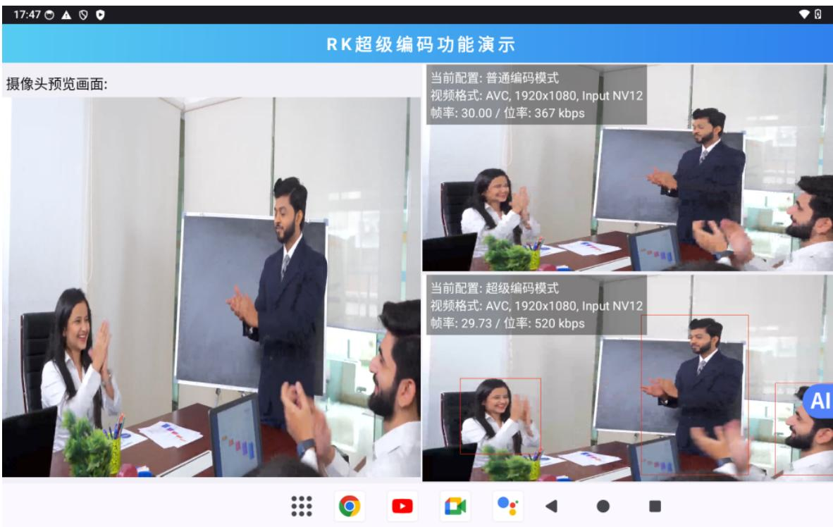
普通编码(右上) vs 智能编码(右下), 可以看到在 300kbps 低码率下, 智能编码模式通过引导码率优化分配, 降低部分背景区域的画质, 依旧能保持人像区域较好的画质输出。
