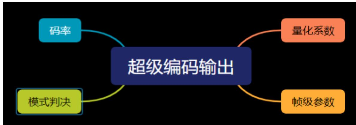
根据输入图像信息自适应分配码率，对于不同场景下的图像会适当优化编码策略且调整码率以达到节省的目的，相较于 CBR 方案，复杂区域分配更多码率，提升主观效果，优化了运动拖尾及马赛克等问题。
