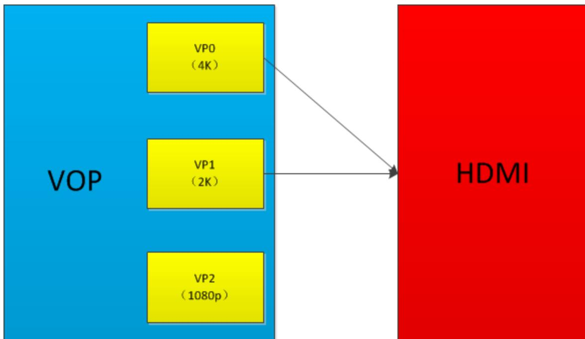
HDMI 可以绑定在 VP0 或 VP1 上，建议绑定 VP0 可以支持 4K 输出：
