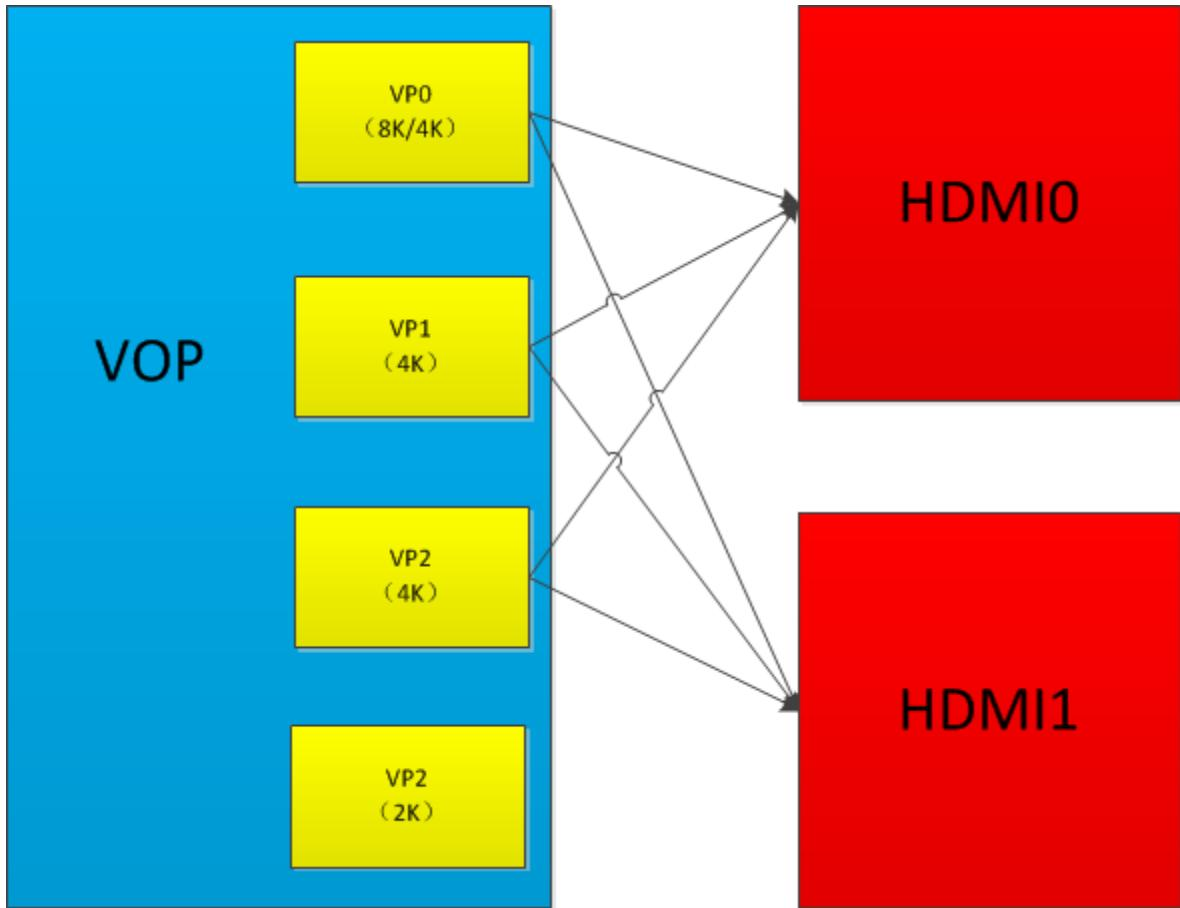
RK3588 有两个 HDMI TX，两者在性能上完全相同，分别可以绑定在 VP0/1/2。
