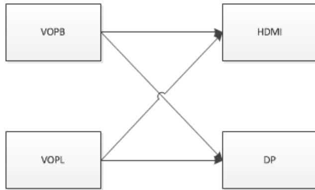
当 dts 中显示设备节点打开时，显示接口对应 VOPB 和 VOPL 的 ports 都会打开，所以需要关闭用不到的那个 VOP 对应的 port。
