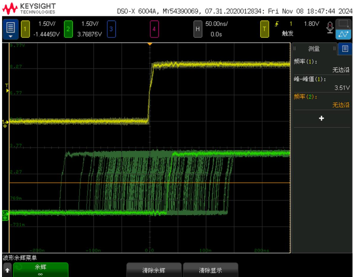
从上图可以看到的是，两台设备在经过 PTP1588 同步后，经过一段时间输出的 PPS 信号在示波器上看到的抖动余晖时间与 ptp4l 测试的 master offset 时间差结果是基本相符的。
