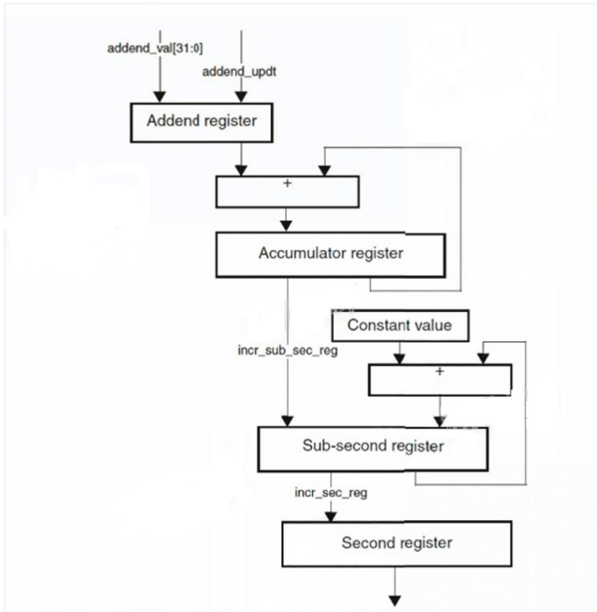
如上图所示, 在校正 GMAC PTP1588 的系统时间方法中, 从时钟 (clk\_ptp\_ref) 相对于主时钟 (IEEE 1588-2002 中定义) 的频率偏移或频率漂移在一段时间内进行校正。这有助于保持线性时间, 并且不会在 PTP 同步消息间隔之间的参考时间中引入剧烈变化 (或大抖动)。在此方法中, 累加器将加数寄存器的内容相加, 如上图所示, 累加器生成的算术进位用作脉冲来增加系统时间计数器。累加器是 32 位寄存器, 充当高精度频率乘法器或分频器。
